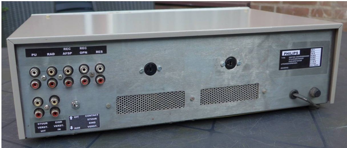
Figuur 2. Achterzijde, nu voorzien van cinch bussen
