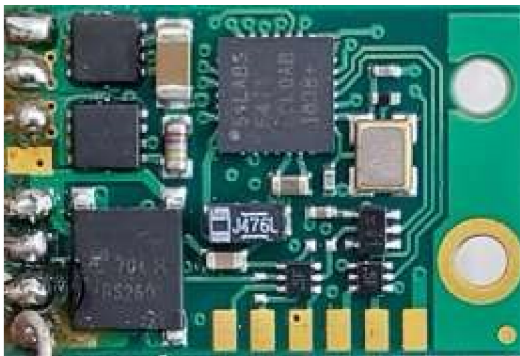
Vorderseite des Lokomotivdecoders Märklin KN160725A Rückseite des Märklin KN160725A Lokomotivdecoders
