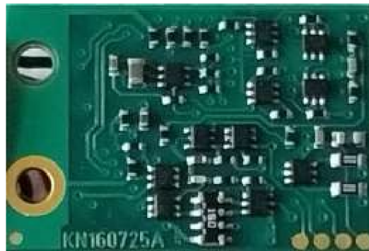
Vorderseite des Lokomotivdecoders Märklin KN160725A Rückseite des Märklin KN160725A Lokomotivdecoders
